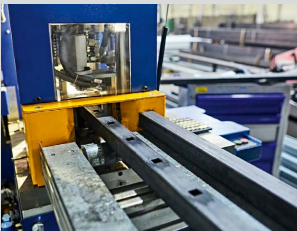
HERAUSSCHLAHEN VON BOHRUNGEN IM FORMER EINES ZAUNFELDES, DAS IN DER DURCHDRINGUNGSECHNOLOGIE ANGEFERTIGT WIRD.
